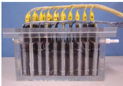
廃水処理用微生物燃料電池の実験装置
