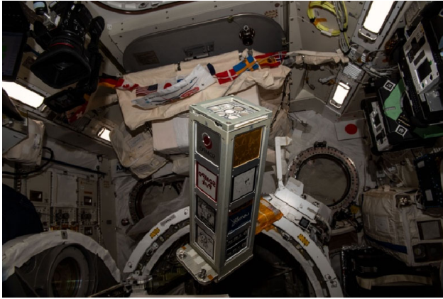
図 4. 左：国際宇宙ステーション（ISS）船外実験プラットフォーム（中型曝露実験アダプタ、i-SEEP）に設置された曝露実験ブラケット（ExBAS）。一番上に、「たんぽぽ」実験の曝露パネルが格納された。右：宇宙飛行士により、ISS 内で「たんぽぽ」実験の曝露パネルが ExBAS に取り付けられた。曝露パネルには、七つの曝露ユニットにヒメツリガネゴケの胞子体を含む多様な試料が収められている。本研究ではこの装置を用いて、約 9 か月間宇宙空間に曝露した。（提供：JAXA/NASA）
