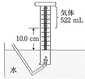
問1 10.0 cmの水柱がその底面に及ぼす圧力は何Paに相当するか。最も近い値を次の①～⑥から一つ選びなさい。なお、水柱が及ぼす圧力は水柱の高さに比例し、高さ1.00 cmの水柱が及ぼす圧力は98.0 Paとする。(解答欄2-ア)
